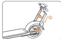
1. サポートパッドを片側に寄せ、リアホイールの左右の固定具を合わせて、リアナンバープレートホルダーに差し込みます。
