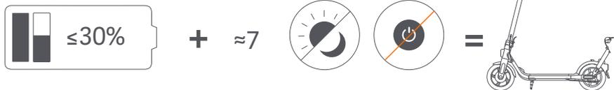
バッテリー残量が30%未満で、スクーターの電源が連続して約7日間オンにならないと、バッテリーはスリープモードに移行します。この場合、スクーターの電源をオンにできません。バッテリーをアクティベートするには、3秒間充電してください。
