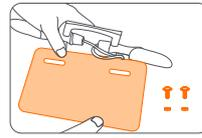
1. ナンバープレートホルダーからM5コンピネットを取り外し、ナンバープレートをねじ穴に対して所定の位置にセットします。
